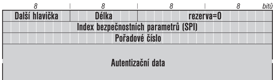
Obrázek 10.5: Hlavička Authentication Header
